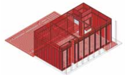
Integratie van een maximaal beglaasde wand
